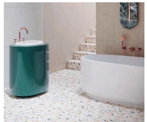
Torneira misturadora de lavatório com 3 furos. Bacia oval de cerâmica semi-encastada de 55 cm. Banheira autónoma de acrílico. Misturador de banho exposto de parede com chuveiro de mão.
