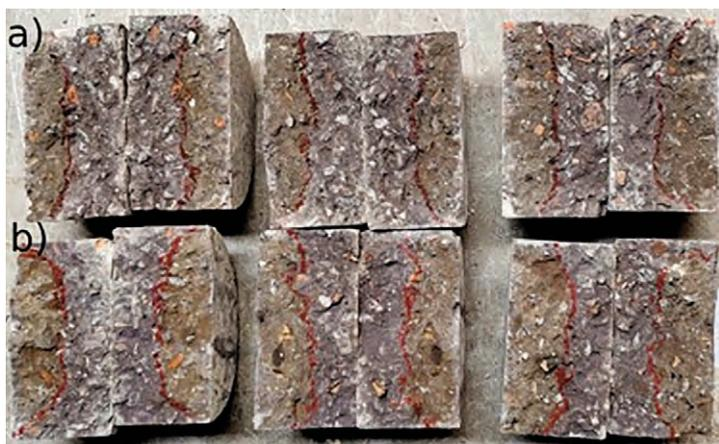
Figura 8: Profundidade de penetração de cloretos: a) betão com incorporação de 25% de RCD; b) betão com incorporação de 25% de RCD funcionalizado com PCM.
