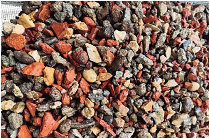
Figura 2: RCD funcionalizado com PCM.
