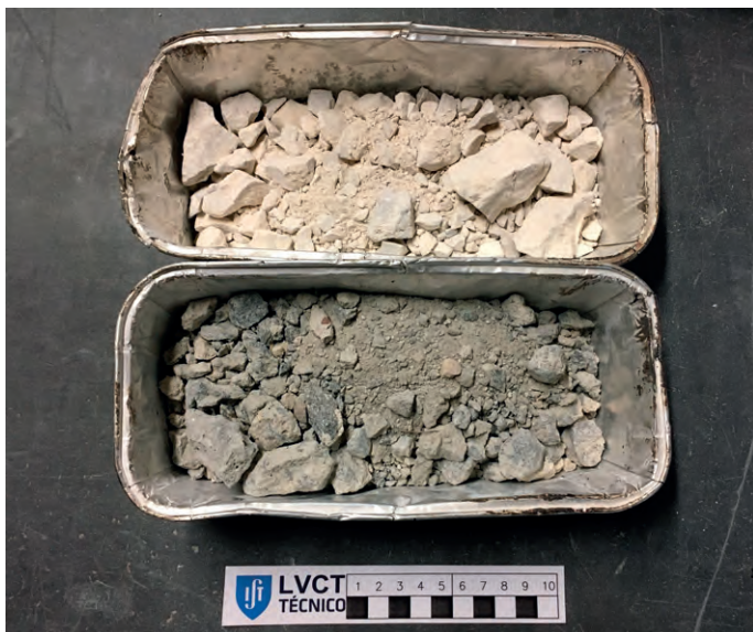
Figura 1. Amostra de agregado natural (em cima) e agregado reciclado (em baixo)
