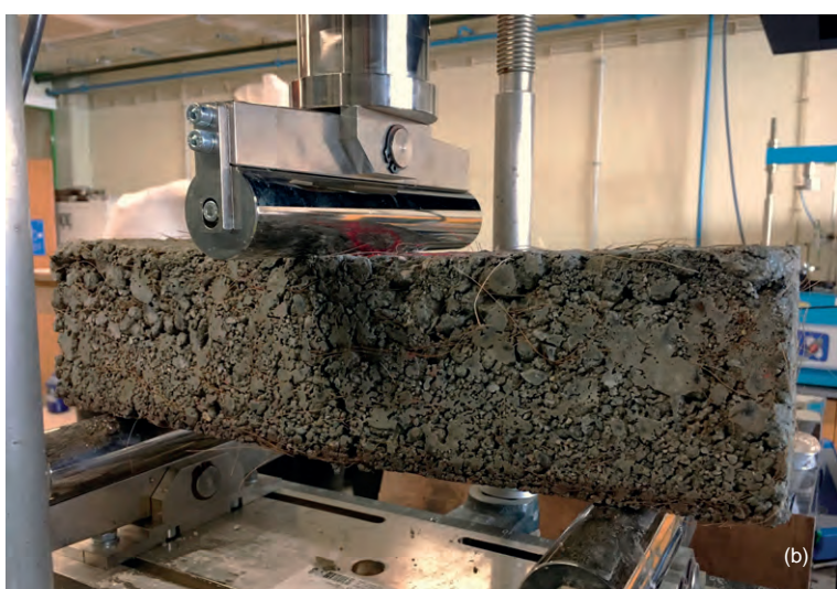
Figura 3. Final do ensaio de RFS em MTC sem FC (a) e em MTC com FC (b)
