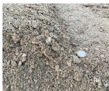
Figura 4. Produção das MTC em central (a), pormenor de MTC com FC (b) e compactação da camada de base (c)
