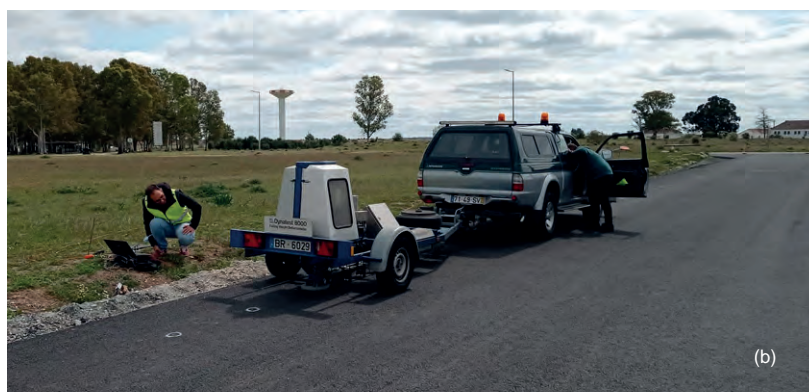
Figura 5. Marcação da localização dos extensómetros (a) e ensaio com defletómetro de impacto e aquisição de dados da instrumentação instalada (b)
